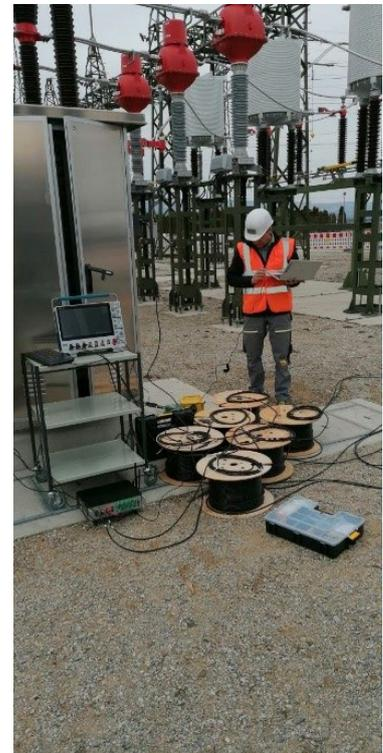
Abb. 2: Messtechnik zur Erfassung schneller Spannungsänderungen
