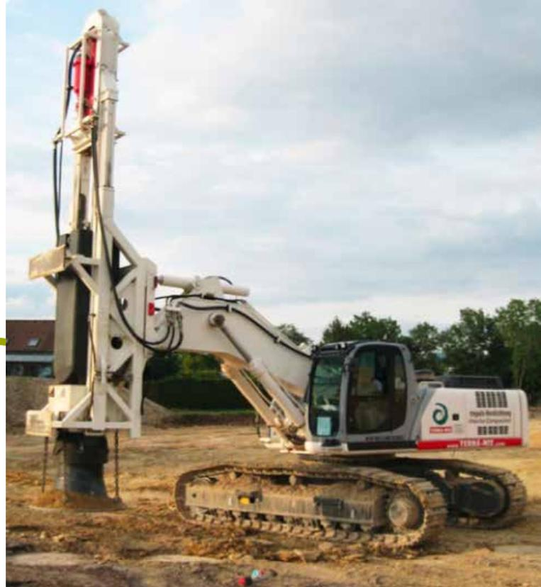
Bild oben: Zur Bodenverdichtung wird ein tonnenschwerer Hammer mit einem entsprechenden Gerät hochgehoben und zur Verdichtung des Bodens fallen gelassen.
