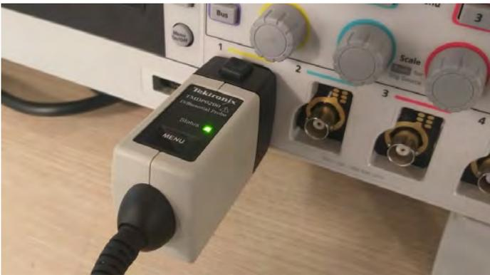
Abbildung 9: TekVPI-Tastköpfe übertragen Skaleneinstellungen, Bereiche und Statusinformationen zum TBS2000B-Oszilloskop.
