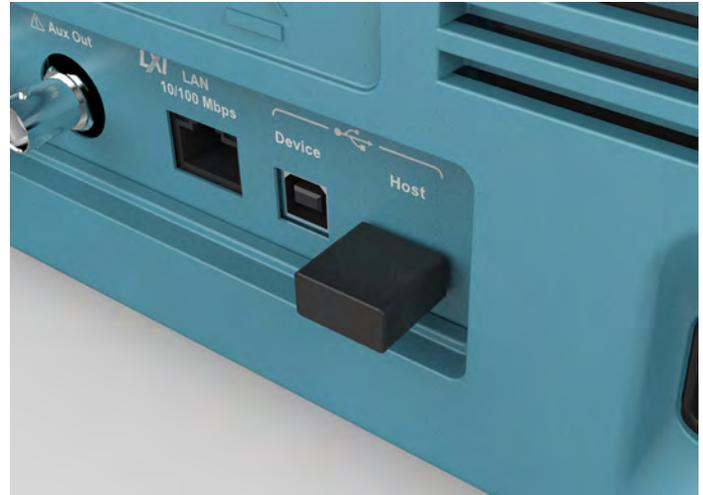
Abbildung 10: WLAN-Adapter werden über integrierte Setup-Menüs konfiguriert und unterstützen den nahtlosen WLAN-Datenaustausch
