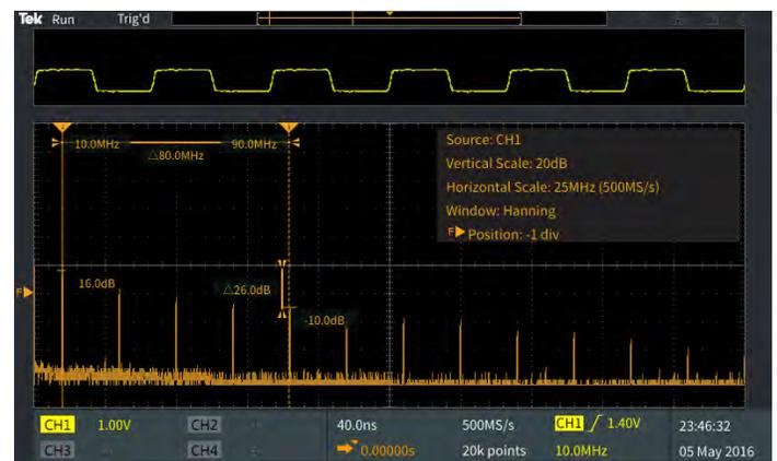
Abbildung 8: Das Quellsignal kann über dem FFT-Frequenzspektrum im Zeitbereich angezeigt werden.
